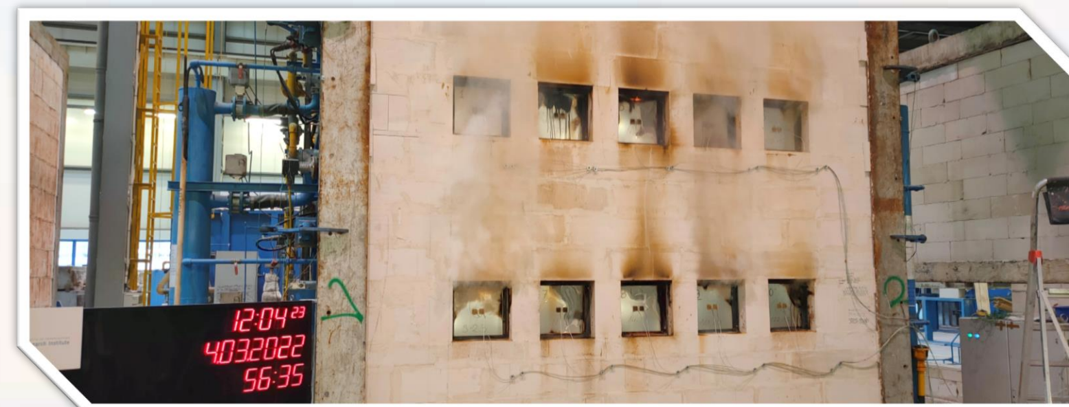
Rys. 5. Elementy próbne w trakcie badania – strona nienagrzewana (czas t = 56 minut).
