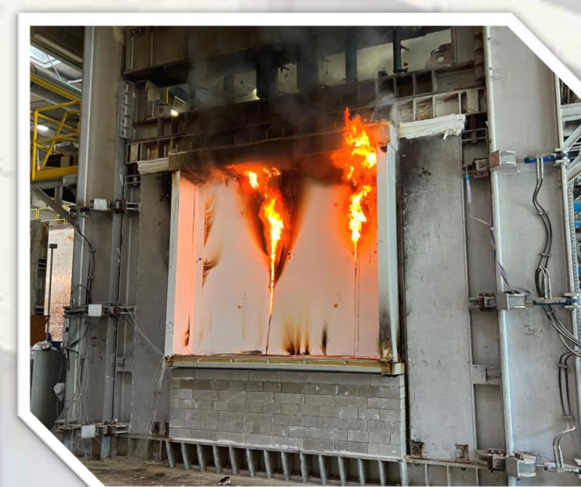
Rys. 7. Utrata szczelności ogniowej (czas t = 23 minuty).
