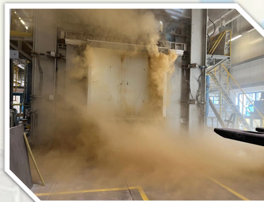
Rys. 6. Zadymienie hali badawczej przy badaniu ściany z rdzeniem PIR (czas t = 3 minuty).
